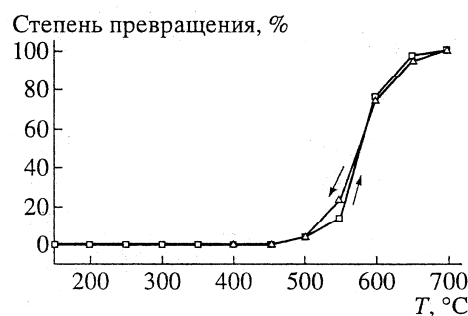
Рис. 2. Зависимость степени превращения \text{CH}_4 от температуры на катализаторе, содержащем 0.3% Pt. Вторичное покрытие – 12% \text{La}_2\text{O}_3 + \text{Al}_2\text{O}_3 . Катализатор прокален при 800°C.
