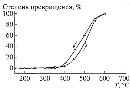
Рис. 1. Зависимость степени превращения \text{CH}_4 от температуры на катализаторе, содержащем 0.3% Pt. Вторичное покрытие – 12% \text{La}_2\text{O}_3 + \text{Al}_2\text{O}_3 . Катализатор прокален при 600°C.
